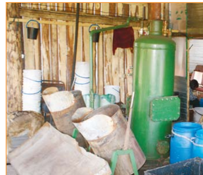
Приемо-заготовительный пункт с грибоварочным котлом
